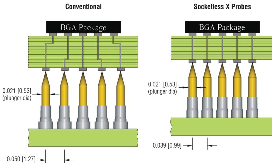
La serie X Probe Socketless se compone de dos partes: La sonda de prueba y el pin de terminación. La sonda está diseñada con nuestro diseño patentado de tubo arrollado con un receptáculo de interconexión modificado en la parte de abajo. Este receptáculo incrementa la longitud del tubo mientras que los demás aspectos de la sonda son iguales. El receptáculo de interconexión recibe al pin de precisión situado en la parte superior del pin de terminación.
