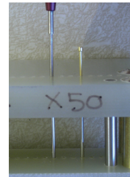
Uso correcto de la herramienta de extracción con los platos de espaciamento y sondas instalados.
