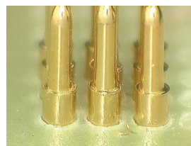
Raspones a puntos de retención dejan rebabas de metal que pudieran causar cortos eléctricos.
