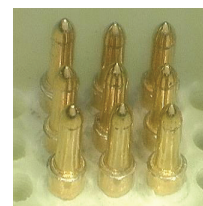
Material de platos de montajes puede desplazarse debido a martilleo excesivo.
